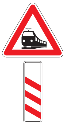
تقاطع جاده و راه آهن بدون راهبند نصب در ۳۰۰ متری
