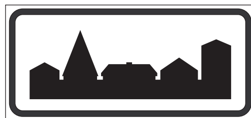
ابتدای منطقه مسکونی
